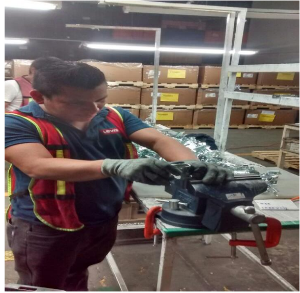
Fig.2.5.- Retrabajo de desfase de Base Plate
