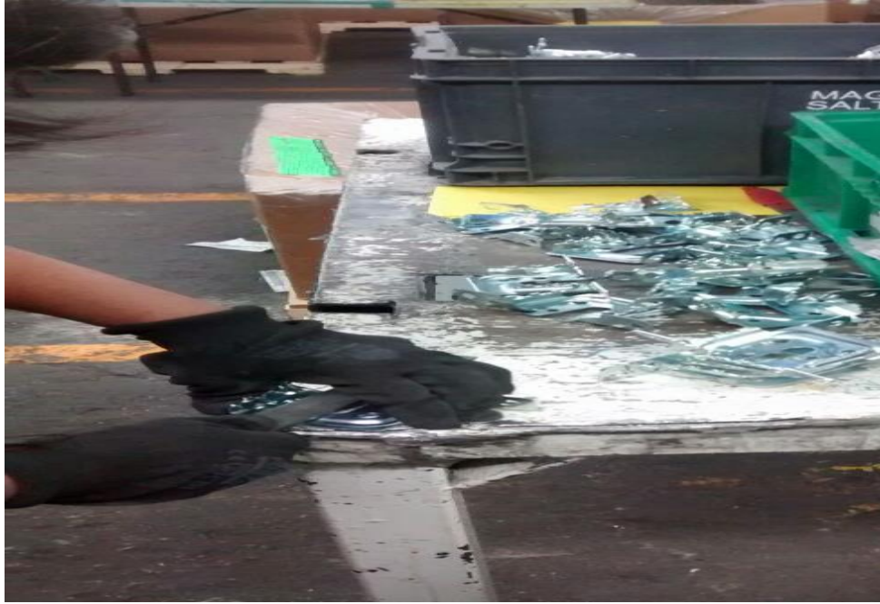
Fig.1.1.- Eliminación de rebaba con lima
