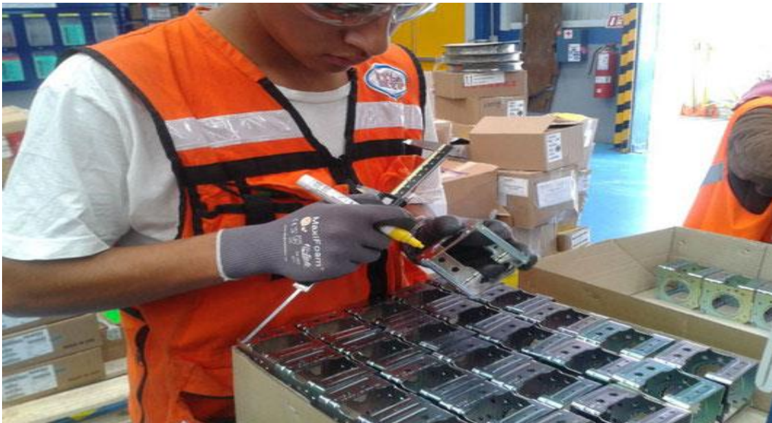
Fig.15.-Aplicando Punto de compra con marcador para garantizar que se realizó la inspección.
