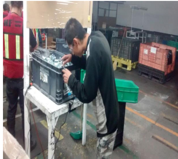
Fig.2.7.- Retrabajo de Base Plate con esmeril
