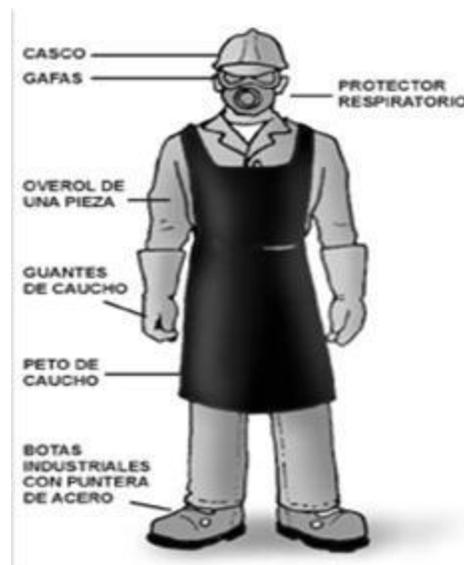
*Ilustración 15. Equipos de protección a utilizar*
