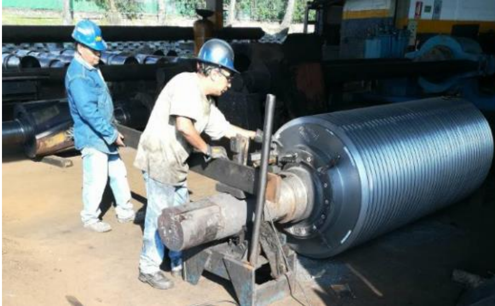
Ilustración 4. Esta fotografía muestra el trabajo de barrenado a una maza bagacera.
