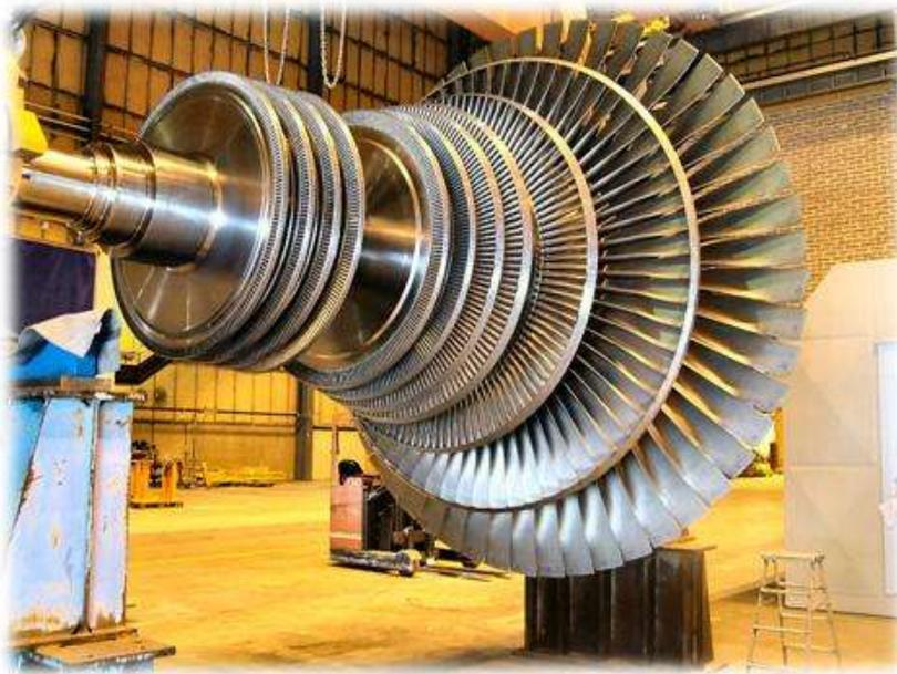
ilustración 6 en esta imagen se pueden observar los tres tipos de reacción, de izquierda a derecha, alta presión, mediana presión y alta presión.
