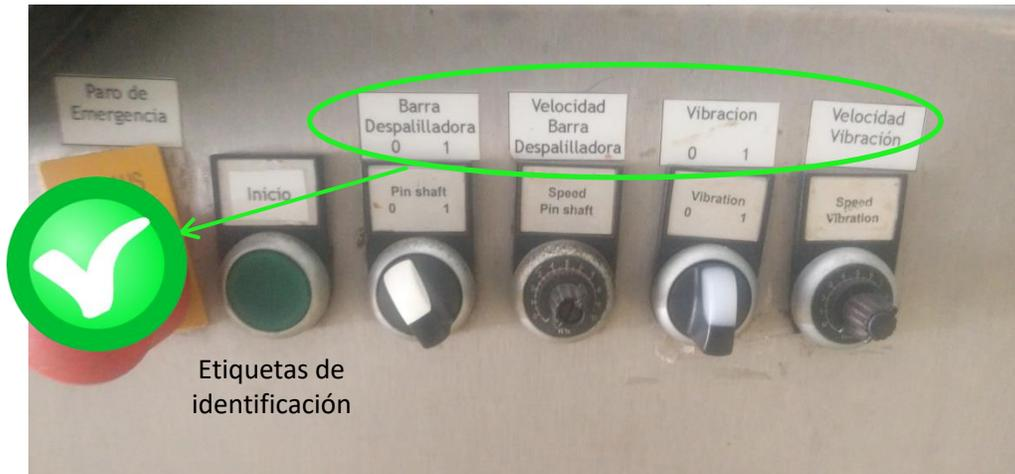
Ilustración 11. Botoneras de despalillador de uvas.
