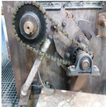
Ilustración 38 Sistema mecánico - neumático de la secadora.
