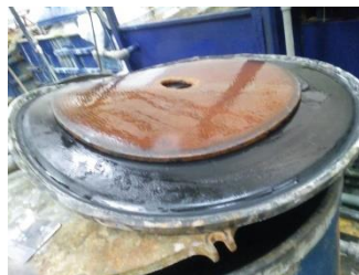
Ilustración 23 Filtros atrapa grasa y rebabas
