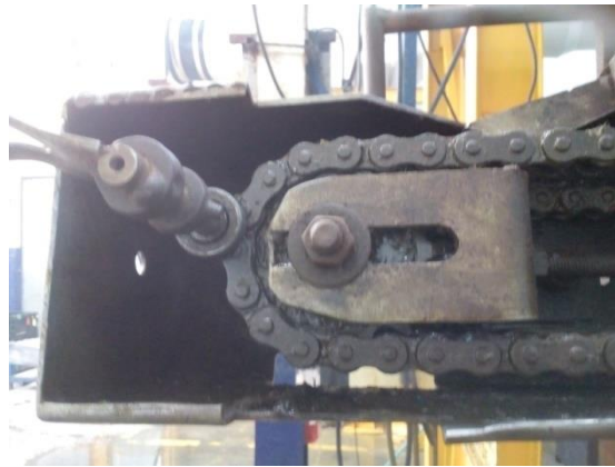
Ilustración 32 Sistema de cadena y sujetadores de racks.
