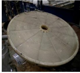
Ilustración 24 Trampas del filtro de zinc.
