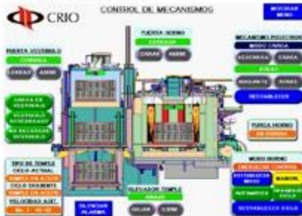
Fig 1.6 En la siguiente imagen se muestra la pantalla de mecanismos en decir donde se controlan los mecanismos que conforman el horno UBQ - 004.
