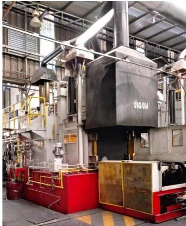
*Ilustración 1 Horno UBQ - 004 Línea Batch*
