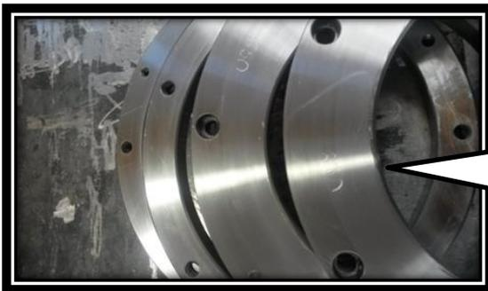
Se realizó el maquinado de anillos centradores con el fin de obtener las mejores condiciones en el equipo. Eliminar escusas.
