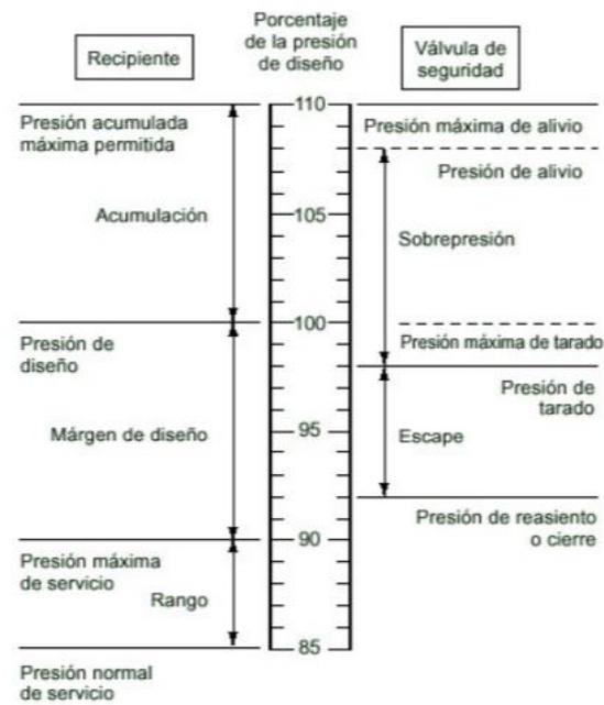
*Ilustración 9: Régimen de presiones para una válvula de seguridad*
