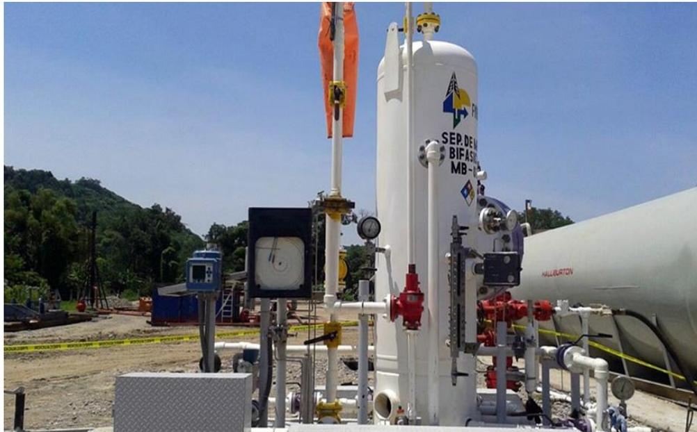
*Ilustración 4: Separador cilíndrico vertical*
