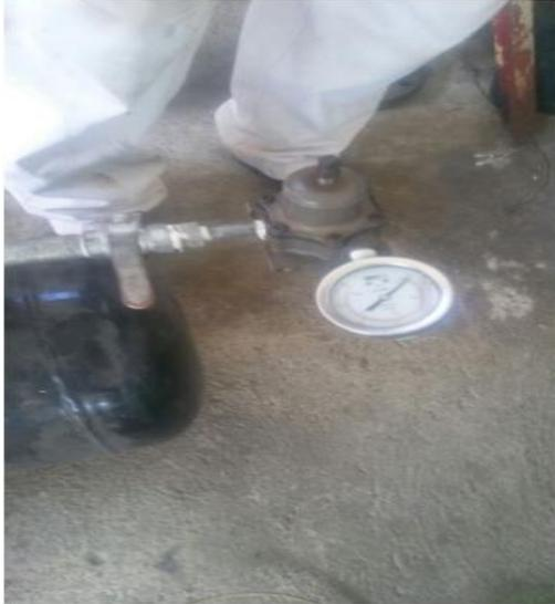
Se necesita un compresor de aire de 2 hp para poder simular el gas suministro con el cual funciona el 12 PL este mismo funciona con presión de 25-30 psi, para poder lograr ese libraje necesitamos un regulador de baja presión (este regulador se ocupa solo si el 12 PL no lo tiene) con su respectivo manómetro, el cual va restringir el pase de aire con el vástago de calibración y lograr la presión de trabajo del 12 PL.
