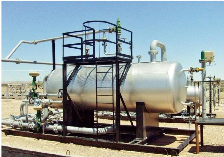
*Ilustración 3: Separador cilíndrico bifásico horizontal*
