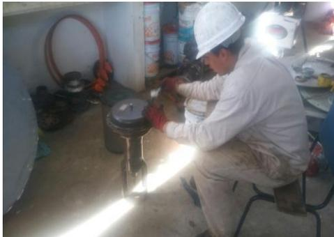
Posteriormente de realizar todos estos pasos se procede a armar la válvula con todos sus componentes previamente desinstalados, la cual se instalara en el separador bifásico y será la parte más importante del dispositivo
