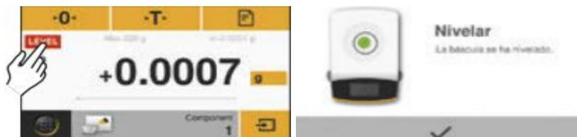
2. Gire las dos patas tal y como se muestra en la figura hasta que la burbuja esté centrada en el círculo del nivel.
