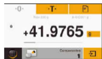
3. Añada el primer componente al recipiente y toque **Qnt** para guardar el peso del componente
