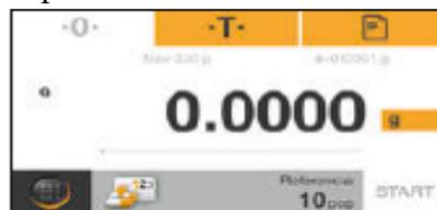
3. Introduzca la cantidad de muestra de referencia (ajuste de fábrica por defecto: 10 unids.); coloque esa cantidad en el recipiente y pulse **STAR**.
