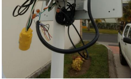
Ilustración 19 Conexión del cable a la Antena RFID
