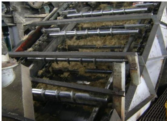
Imagen 5.3 conductor implementado
