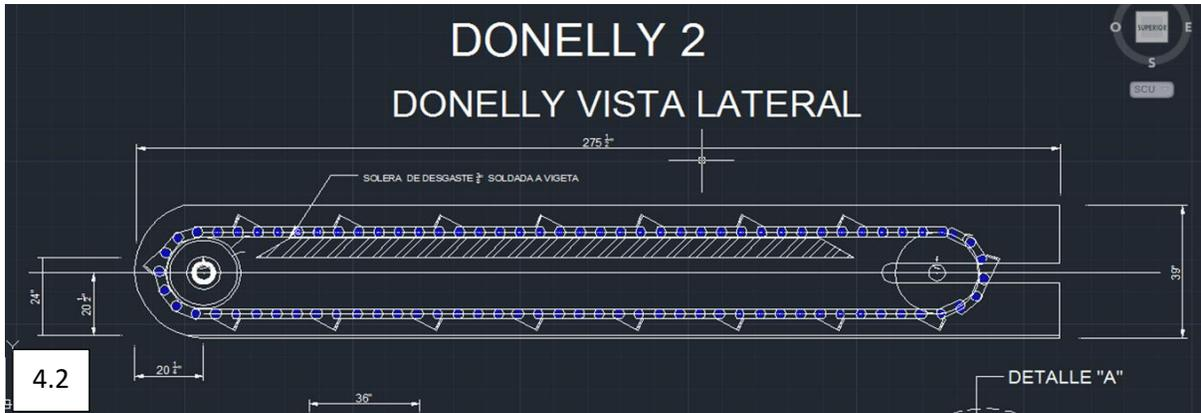
Imagen 4.2: Dibujo de posición de cadena 5025.
