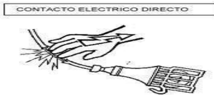
FIGURA: 3.9 Contacto eléctrico directo.
