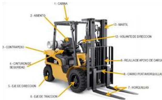
Imagen 1: Partes del montacargas
