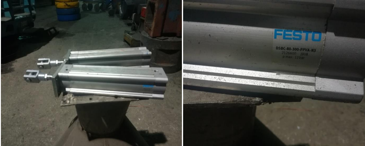
Imagen #4.15 y #4.16.- Pistón neumático Festo de doble efecto.
