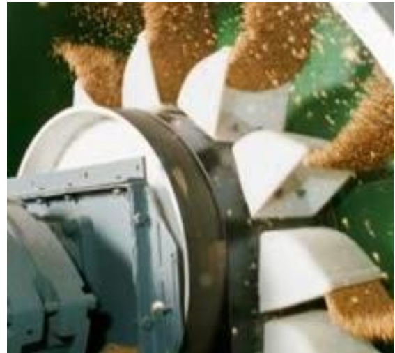
Imagen # 2.2.- Elevador tipo cangilón transportando azúcar.
