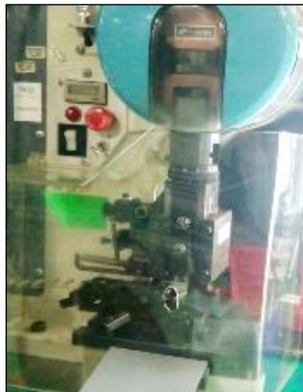
Figura 17. Aplicador de prensadora
