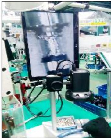
Figura 19. Inspección en cada prensado de terminal
