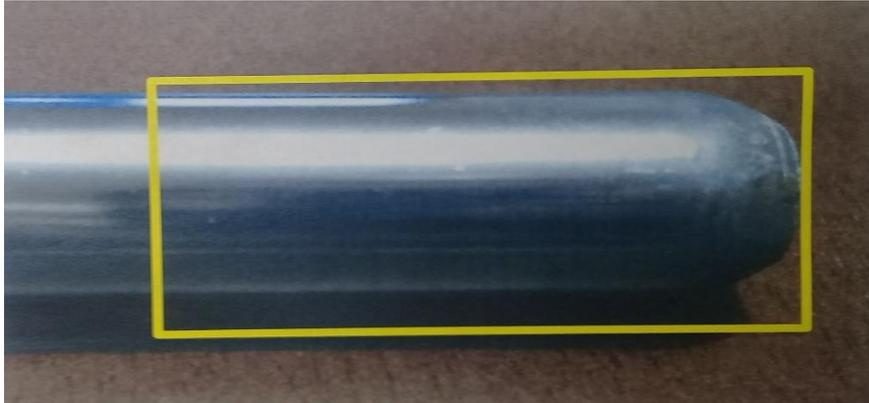
*Figura 3.26 Pieza con punta quemada de cromo*
