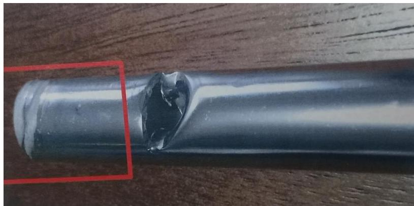
*Figura 3.17 Pieza con punta quemada de níquel*
