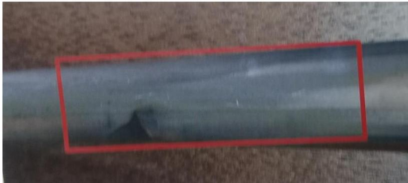
*Figura 3.18 Pieza con falta de Níquel*
