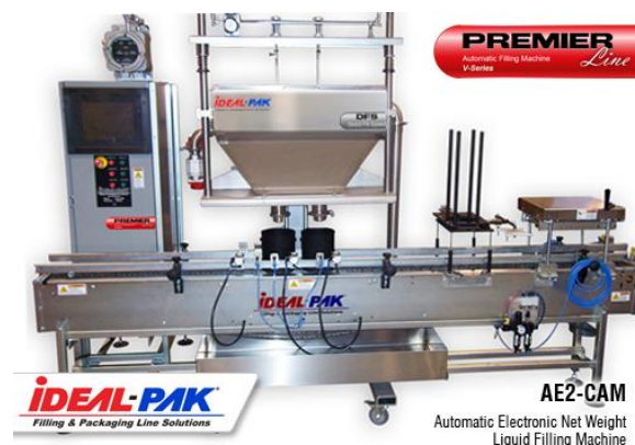
Fig. 14.- Máquina Llenadora Automática Modelo Premier AE2-CAM.
