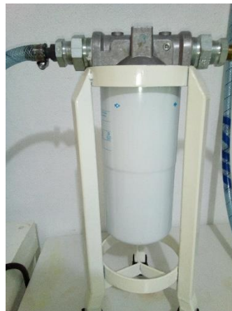
Fig. 43.- Filtro para retirar impurezas del producto extraído.
