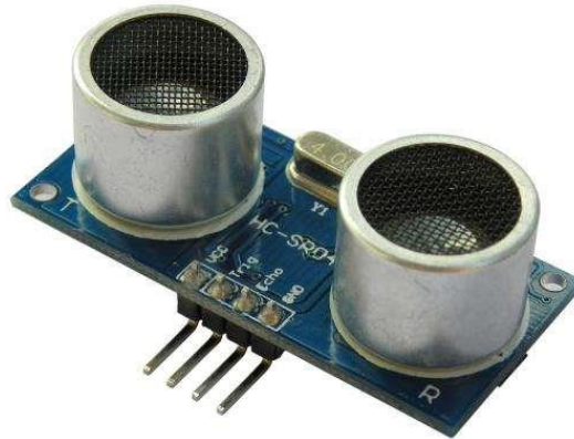
Fig. 18.- Sensor Ultrasónico Modelo HC-SR04.
