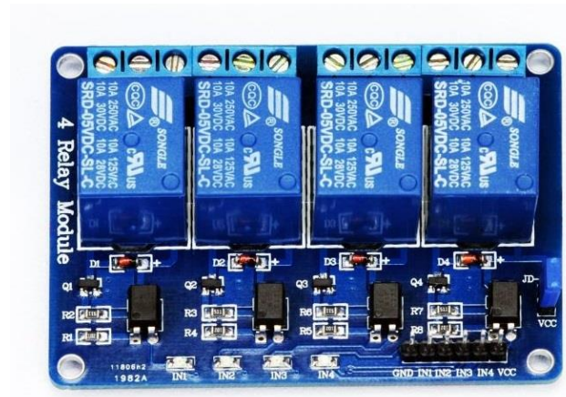
Fig. 20.- Módulo de 4 Relevadores (4 Canales) 5 VCD.
