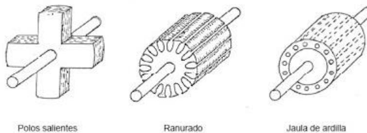
Imagen 15 (Tipos de rotores)
