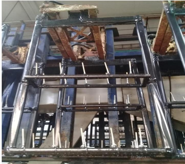
Figura 5.- En la figura se muestra se muestra el rack donde van las piezas rectas.
