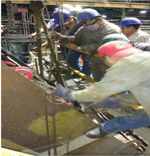
Figura 1 Descarrilamiento del elevador de bagazo
