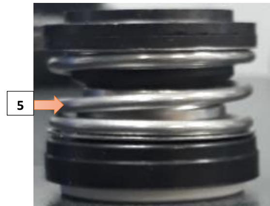
Ilustración 23 sello mecánico bomba
