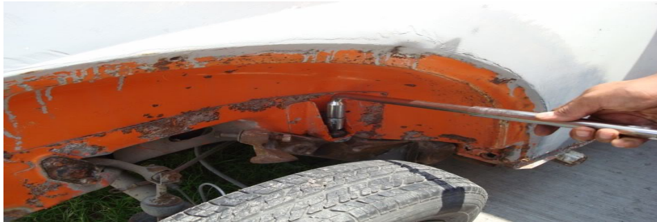
Ilustración 4 Ubicación de los tornillos colocados en las bases de los amortiguadores.
