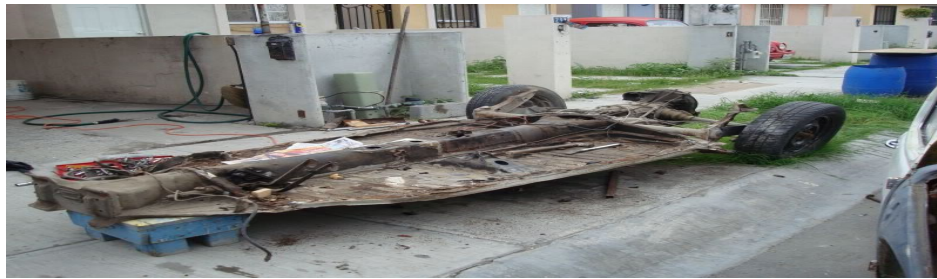
Ilustración 6 Cascaron completamente retirado del vehículo Vw Sedan.
