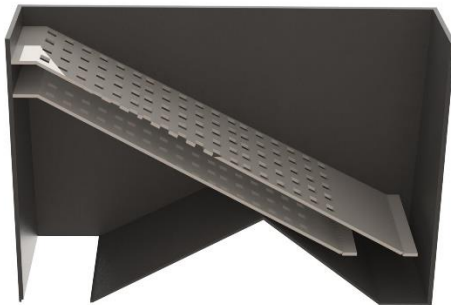
Fig. 5 Vista de corte del tamizado
