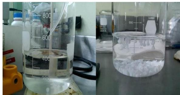
Figura 9. Formación de perlas de HAp nanométrica/CHI
