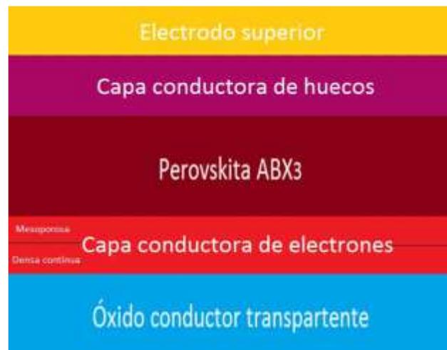
*Ilustración 6 Estructura de la Celda Solar Orgánica*
