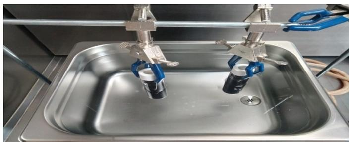
ILUSTRACIÓN 11. Muestras en el baño ultrasónico
