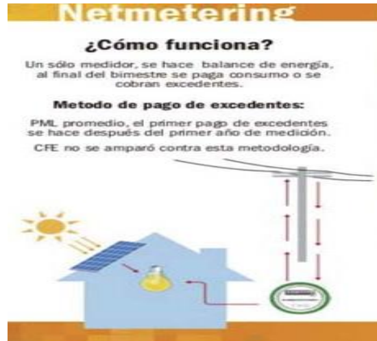
Ilustración 5. Medición Neta de Energía
