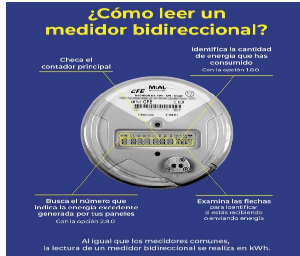
Ilustración 20. Interpretación de Medidor Bidireccional
