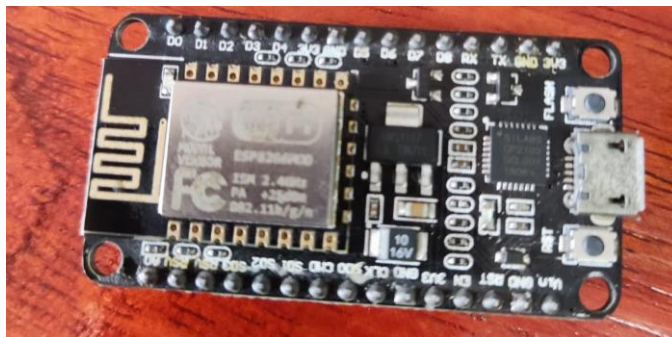
Ilustración 57: Microcontrolador ESP-8266 dañado.
