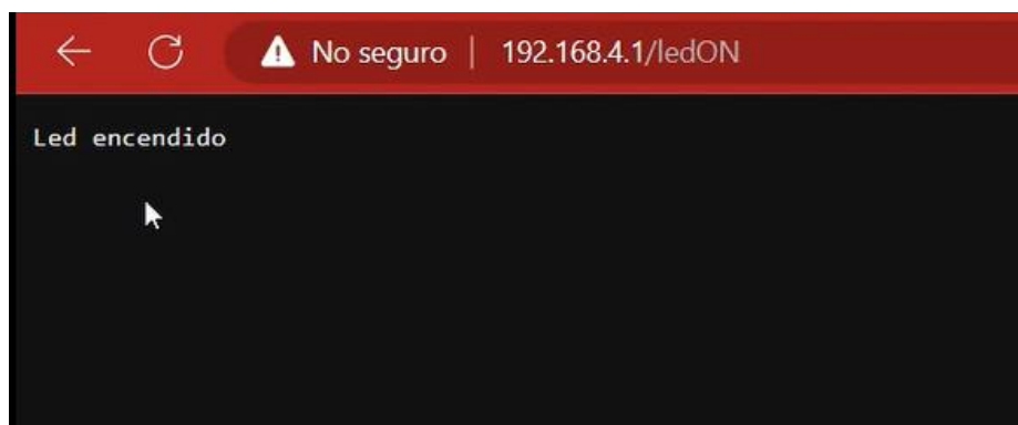
Ilustración 53: Encendido del LED desde la página web.
