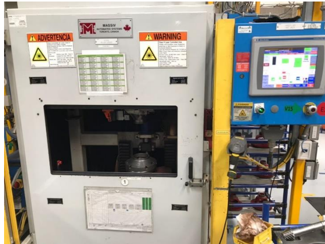
Línea de AUDI Estación 30 soldadora láser
