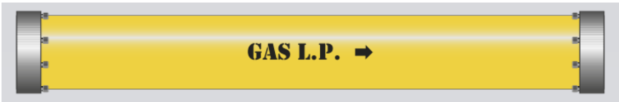
Ilustración 12 Aplicación del color de seguridad a lo largo de la tubería.
