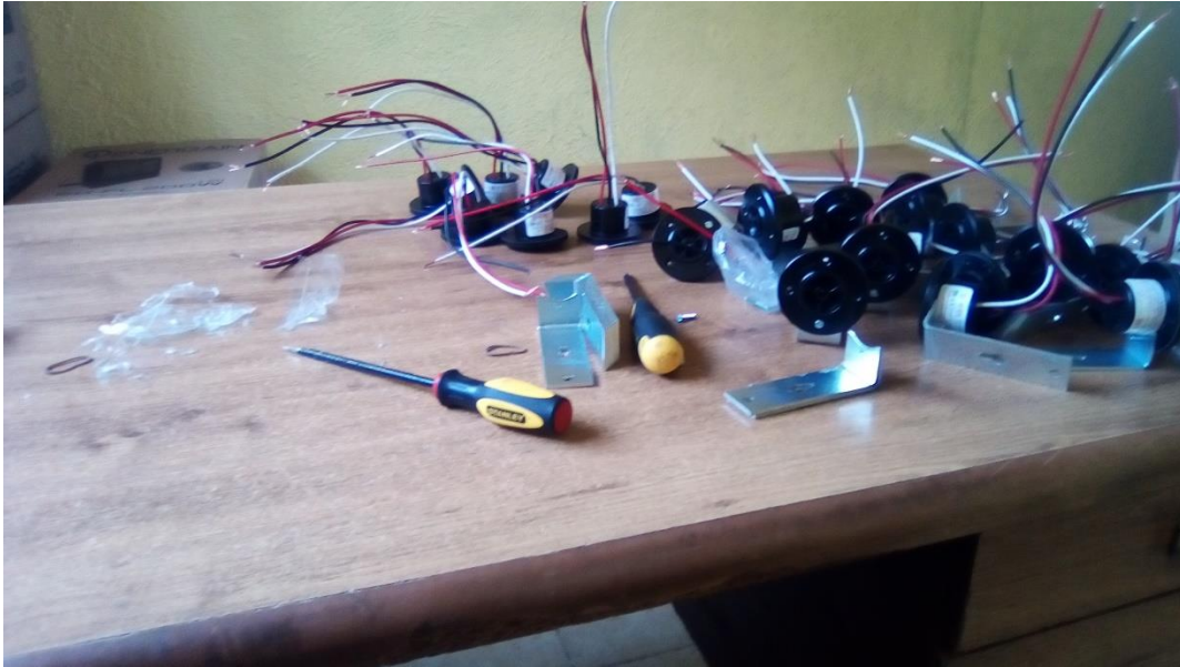
Imagen 5. Ensamble de ménsulas a receptáculos para luminarias
