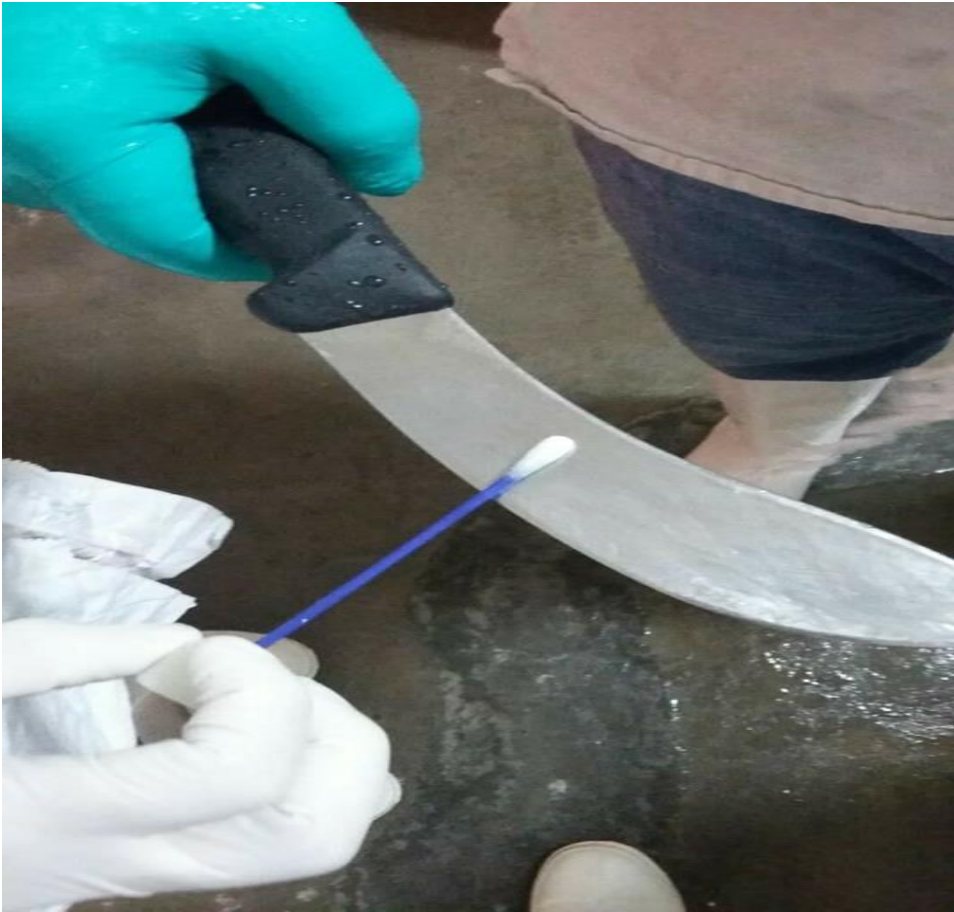
Figura 4. Toma de muestra cuchillo pre-operativa mediante hisopado.
