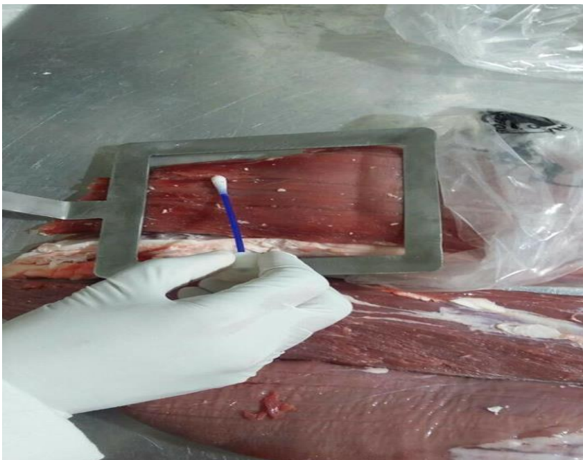
Figura 5. Toma de muestra en mesa de proceso pre-operativa mediante hisopado utilizando plantilla de acero inoxidable 10 x 10 cm.
