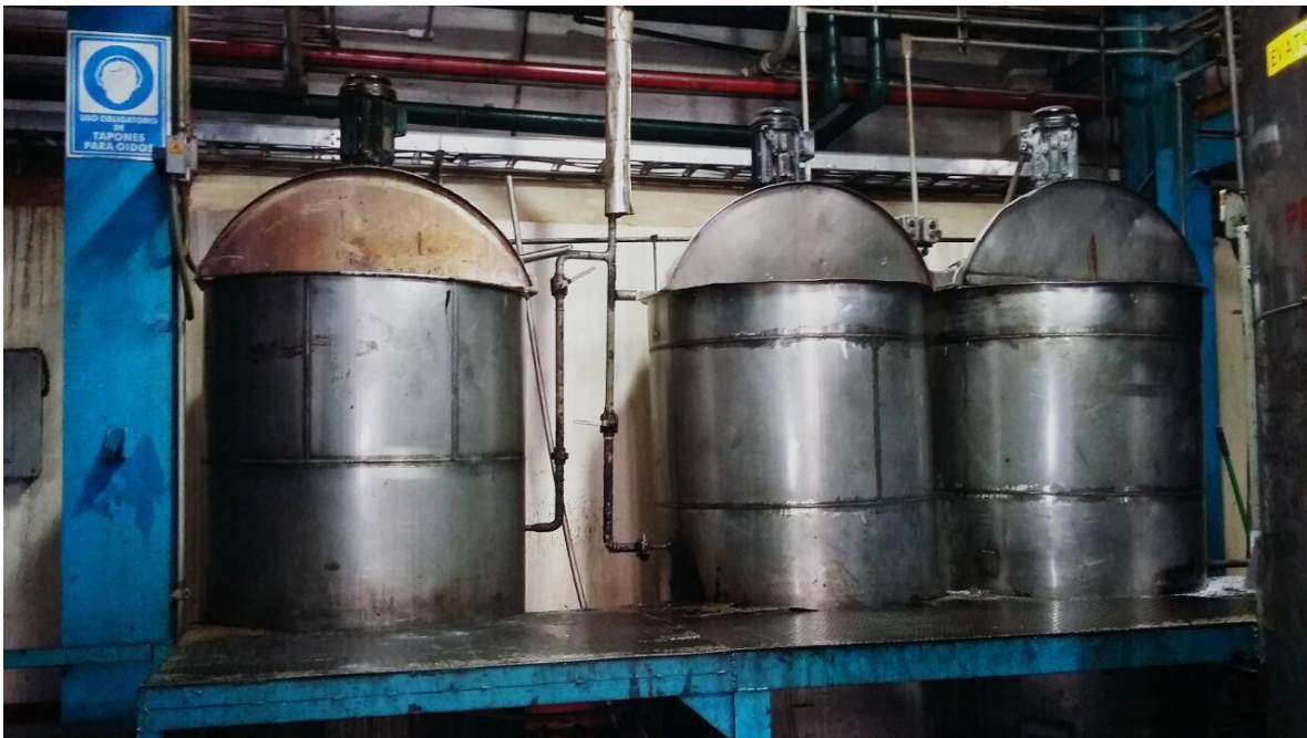
Figura 5. Tanque con capacidad de 1500 kg.
