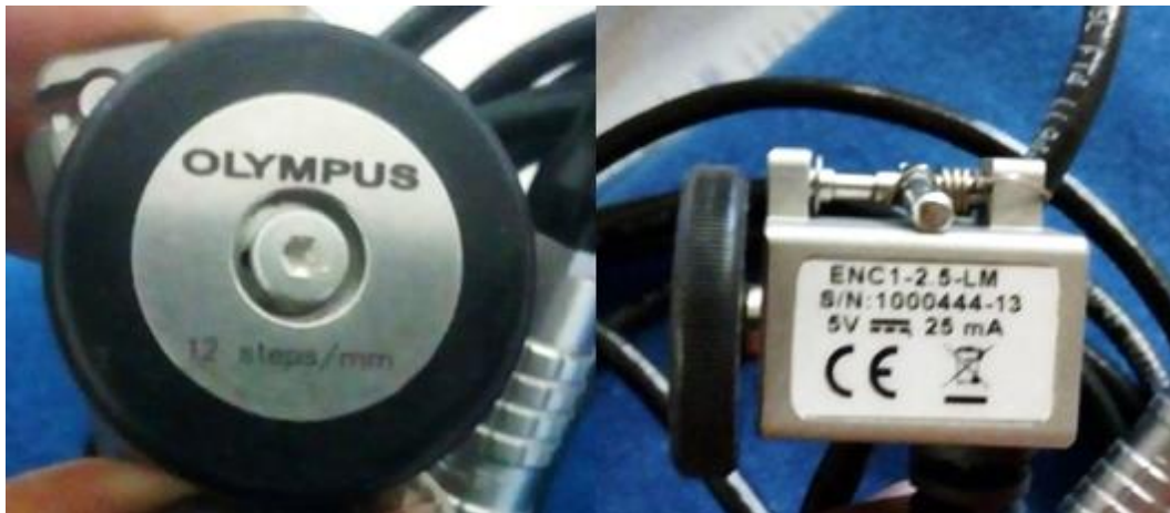
Fig. 3-36 Mini encoder LEMO 2.25M (Partes).
