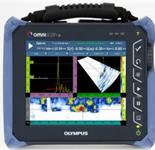
Fig. 1-1 Equipo de ultrasonido PA OmniScan SX PA.
