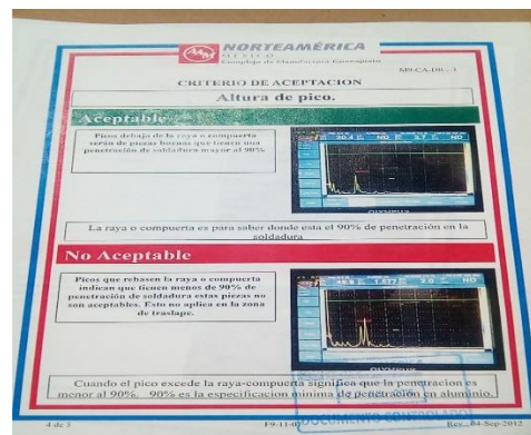
Figura 32 Criterios de aceptación de acuerdo a la altura de pico.
