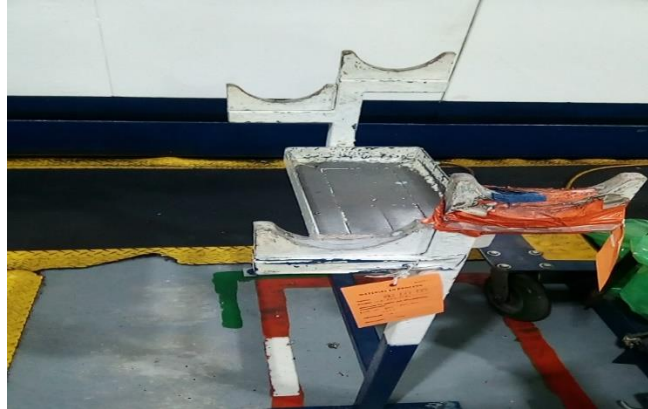
Figura 38 Base para colocación de flechas actual.
