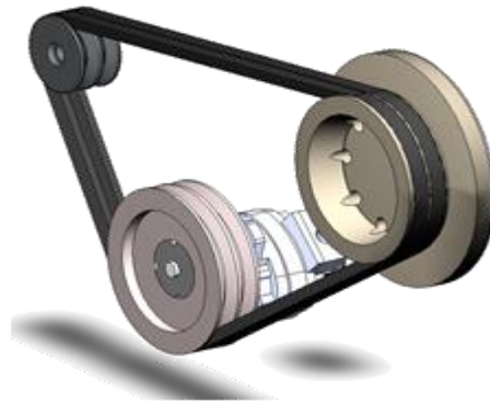
Figura 21 Sistema de transmisión de poleas.
