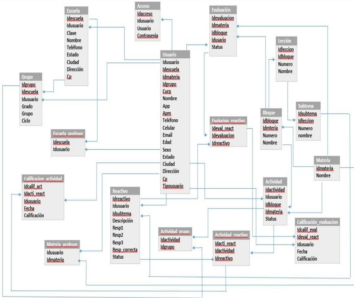
Figura 5. Diagrama relacional de la base de datos de aplicación IMAT
